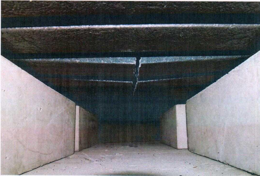
Fot. 4 Badanie wytrzymałości pod obciążeniem – obraz po badaniu kraty 3
