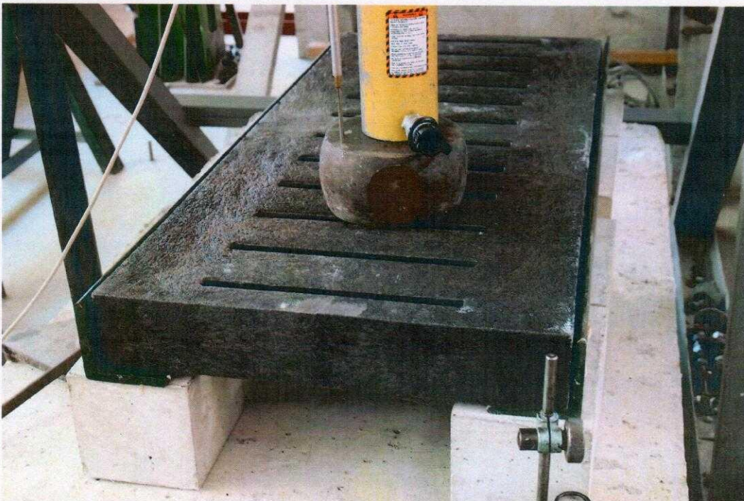
Fot. 1 Badanie wytrzymałości pod obciążeniem – stanowisko badawcze
