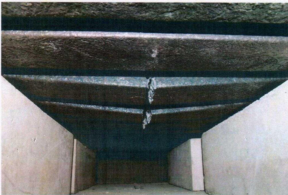
Fot. 2 Badanie wytrzymałości pod obciążeniem – obraz po badaniu kraty 1
